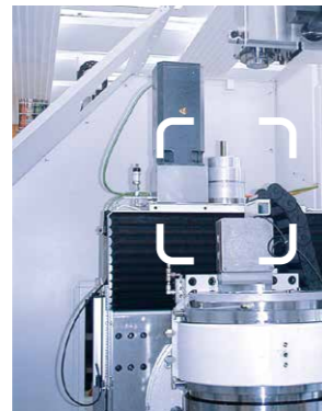
Schleifmaschine Sichern der Z-Achse bei Notaus und Wartung
