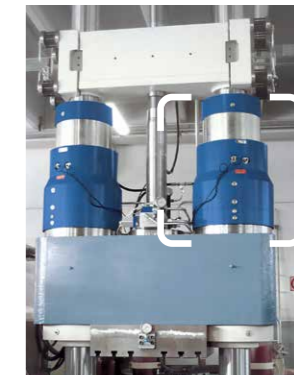
Hydraulische Innenhochdruckpresse Erzeugen von 400 Tonnen Schließkraft
