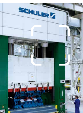
Hydraulische Presse Absturzicherung als DGVV-zugelassene Hochhalte-Einrichtung
