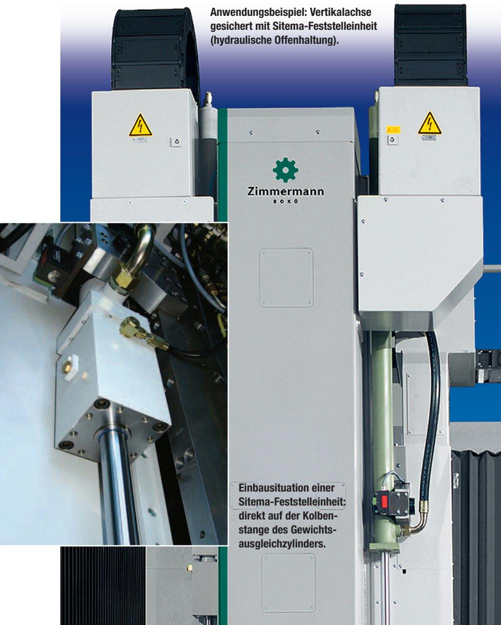
Einbausituation einer Sitema-Feststelleinheit: direkt auf der Kolbenstange des Gewichtsausgleichszylinders.
