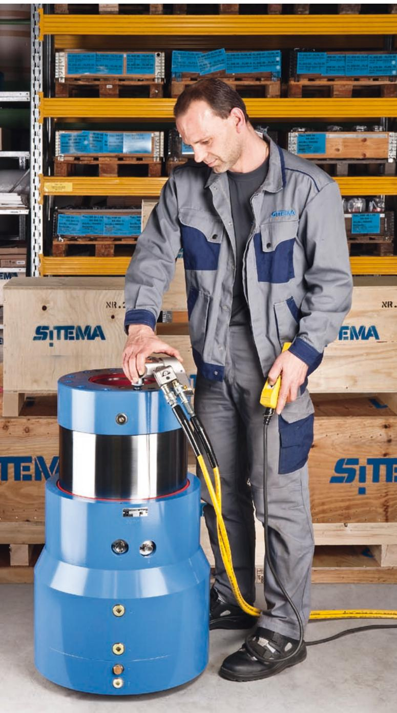
Das Schließen und Zuhalten von Formen und Werkzeugen stellt oft zwei völlig unterschiedliche Anforderungen an den Antrieb: Einerseits muss ein großer Weg mit kleiner Kraft zum Öffnen/Schließen zurückgelegt werden, andererseits muss auf einem kleinen Weg eine sehr große Kraft zum Zuhalten und zum Erzeugen des erforderlichen Druckes aufgebracht werden.
