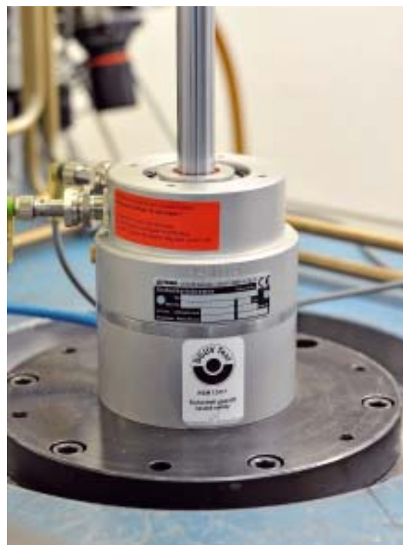
Pneumatische Sicherheitsbremse der Bauart KSP in Einbausituation
