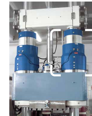
Presse à haute pression interne hydraulique Génération d'une force de fermeture de 400 tonnes
