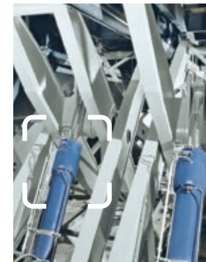
Palcoscenici teatrali sollevabili Mantenimento della posizione a regolazione continua
