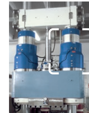
Pressa idroformatrice 400 tonnellate di forza di chiusura
