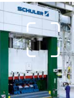
유압프레스 DGUV 안전 승인 Safety Catcher 장착
