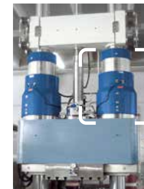
油壓式內部高壓沖壓機 產生400公噸之閉合力
