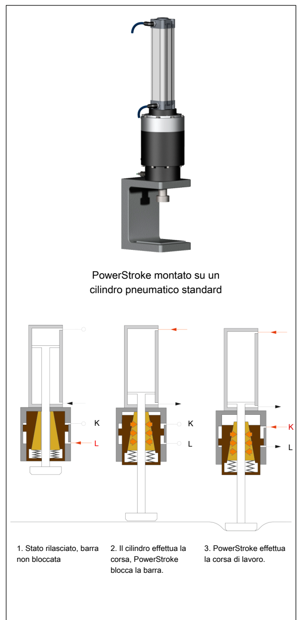
Fig. 1: Esempio: PowerStroke FSKP su cilindro pneumatico
