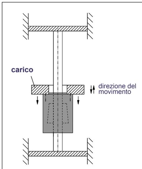
Fig. 4: Fissaggio del dispositivo bloccastelo traslante
