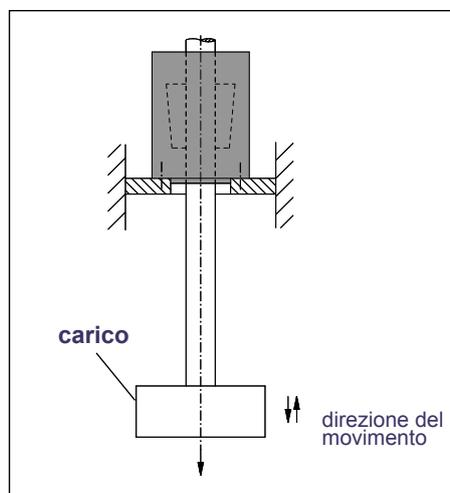
Fig. 3: Fissaggio del dispositivo bloccastelo
