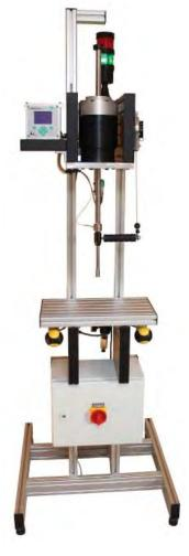
kann zum Beispiel ein falsch montiertes Werkzeug einen vergrößerten Einpressweg zur Folge haben. Ein verkürzter Weg könnte bei einem falsch montierten Element auftreten. Auch außerhalb der Toleranz liegende Bohrungen fallen auf. Sie zeigen sich durch einen verspäteten Kraftanstieg.
