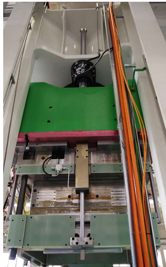
Pressa verticale idraulica tradizionale Cannon (1000T) per HP-RTM e Liquid Lay Down
