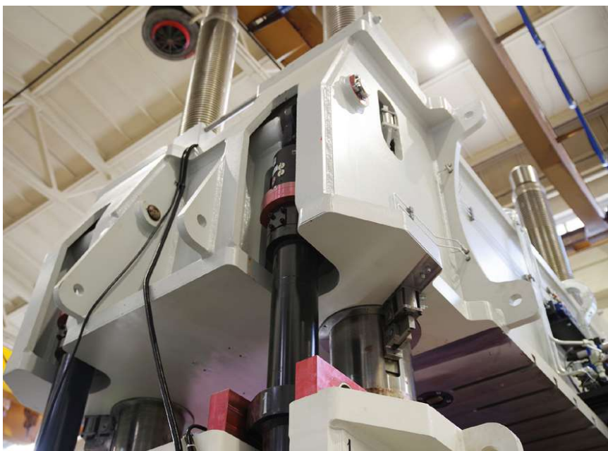
Pressa verticale idraulica tradizionale Cannon (1000T) per HP-RTM e Liquid Lay Down
