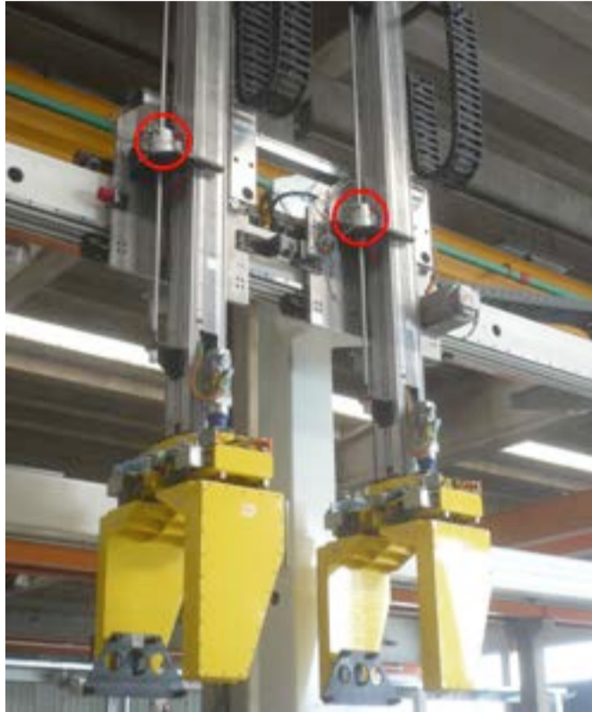
Freno di sicurezza serie KSP a montaggio verticale per portali di carico
