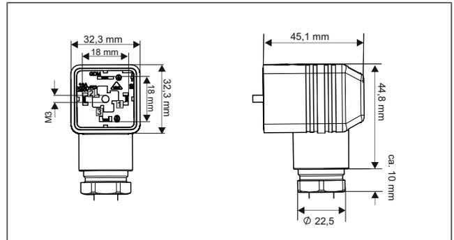
Abb. 4: Ventilstecker am Motorkabel
