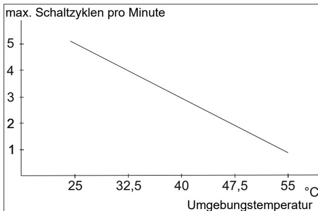
Abb. 2: Abhängigkeit Schaltzyklen/Umgebungstemperatur
